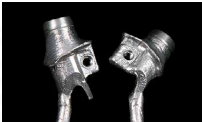
Figura 18: Infraestrutura fundida e limpa por jateamento com microesfera de vidro.
