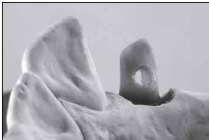
Figura 3: Uma fresagem completa com abertura total é necessária para permitir o jateamento com microesferas de vidro no ato de remoção do revestimento.
