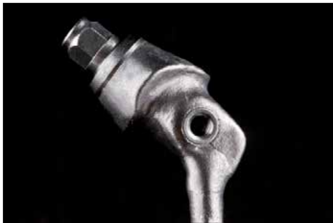
Figura 5: Infraestrutura fundida com liga de cobalto-cromo.
