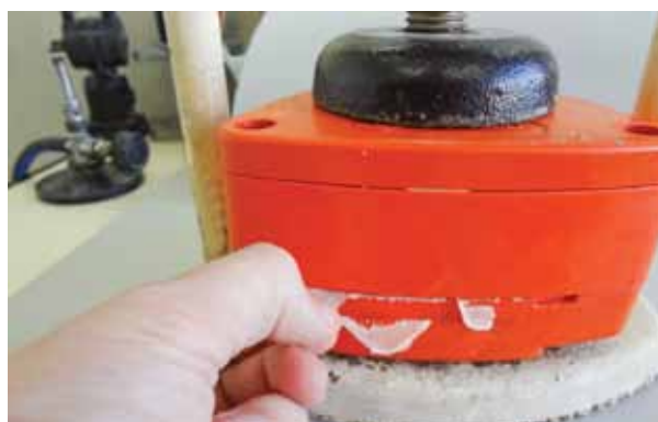
Figura 4C - Observação da fase fibrosa da resina, na qual microfios sustentam a mesma ao tentarmos rasgar.
