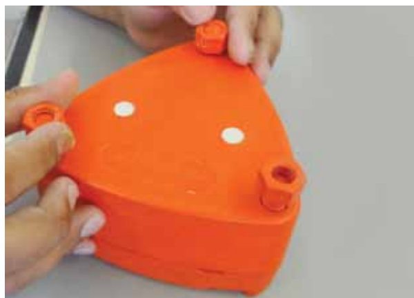
Figura 4K - Colocação dos parafusos na mufla. Posicionam-se os parafusos na mufla e aperta-se os mesmos apenas com as mãos, pois os parafusos tem a única finalidade de estabilizar a prensagem.
