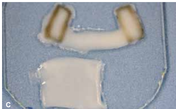
Figuras 4 (A-C) - A) Placa de vidro. B) Marcação das pistas na placa de vidro. C) Confecção das pistas com resina acrílica autopolimerizável.
