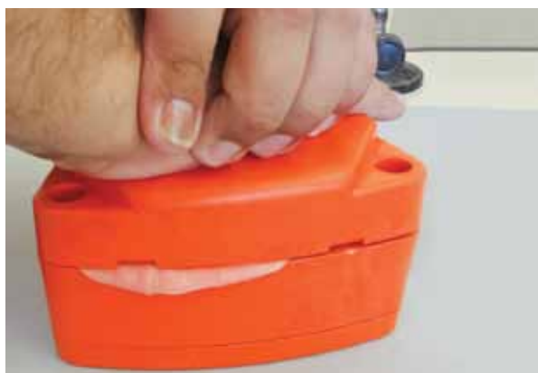
Figura 3H - Fechamento da mufla. Pressiona-se suavemente a base na posição correta contra o triângulo intermediário. O próprio peso da mufla fará a resina escoar e finalizará o fechamento da mesma, que não será total e nem pode, pois a ausência de espaço atrapalharia a passagem de fases da resina.
