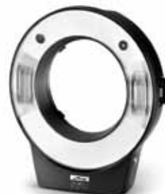
Figura 6 - Flash sem fios da Metz. Observe a aleta lateral, que serve para ajuste da direção da luz. Existem três opções de ajuste, variando a angulação da luz em até 20 graus.
