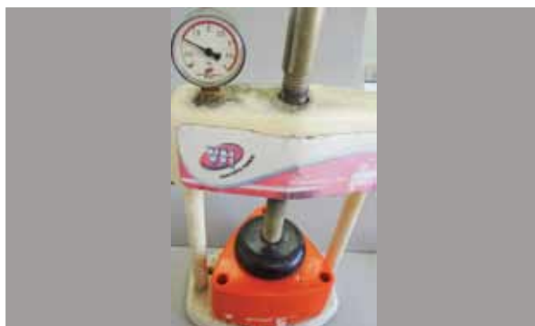
Figura 4F - Prensagem da resina até 1t. Aguarda-se a estabilização da prensagem, devendo sempre refazer a pressão até 1t, que reduz aos poucos conforme a resina é acomodada no interior da mufla.
