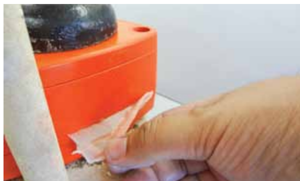
Figura 4E - Verificação da fase plástica da resina. Nesta fase notamos uma maior união entre os fios que sustentavam a resina, demonstrados na prensagem. É possível realmente rasgar a resina e separá-la neste momento. Este sim, é o momento que se aplica 1t de pressão.
