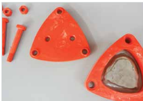
Figura 1G - Esta mufla da Defama é composta por: base e moeda extratora, triângulo intermediário e tampa. É um diferencial vantajoso, pois facilita o preenchimento da mufla, assim como a demuflagem.
