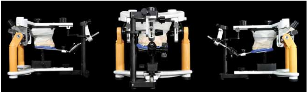
Figura 10 - Montagem do modelo superior em arco facial no articulador semi-ajustável Stratos 200 – Ivoclar Vivadent. Foi aumentado 2mm na dimensão vertical de oclusão do paciente.
